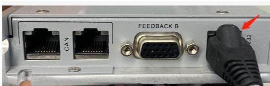
4、将驱动24V口接DC24电源，将接DC48电源，并连接好驱动接地线
