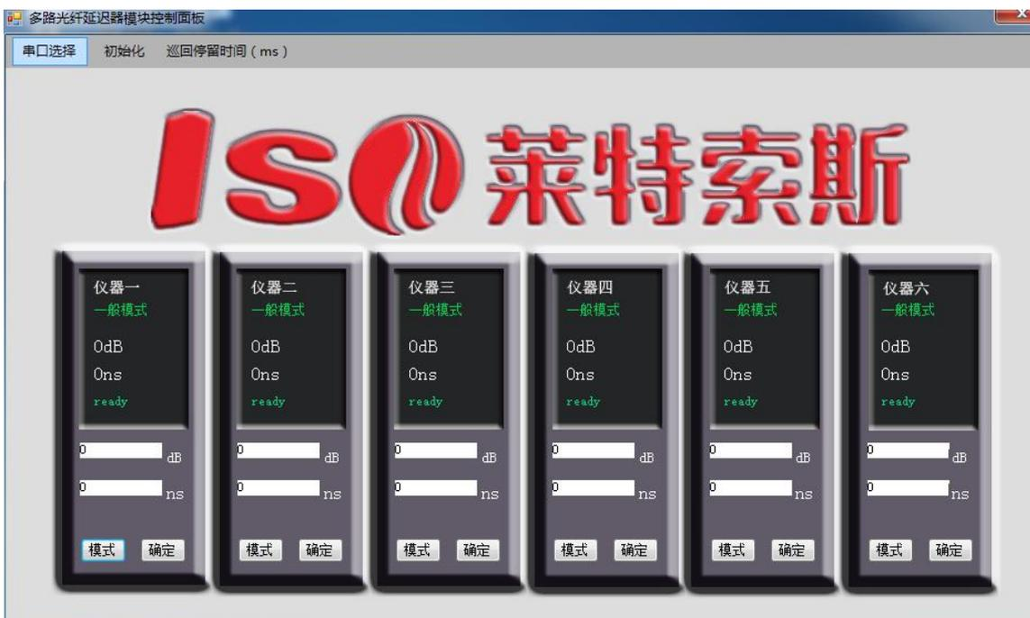
3、有两种运行模式选择（一般模式与巡回模式）打开软件初始化完成后默认一般模式，在一般模式下在相应衰减窗口输入你想要的值按相应窗口下确定就可得到你相应通道衰减值，在延迟窗口输入你想要的延迟值按相应确定键即可得到相应延迟值；如果要巡回模式只需点击模式切换窗口即可切换到巡回模式，在巡回模式下在相应窗口可输入衰减值、巡回延迟起点值与终点值！点击下方开始键，此时仪器会按你设置的衰减以及你设置的起终位置巡回延迟！1~6路可同时操作不同模式！（点击初始化键六路都将归零位）
