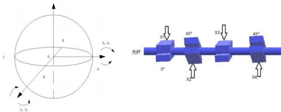
图 3 偏振控制器模块工作原理图
